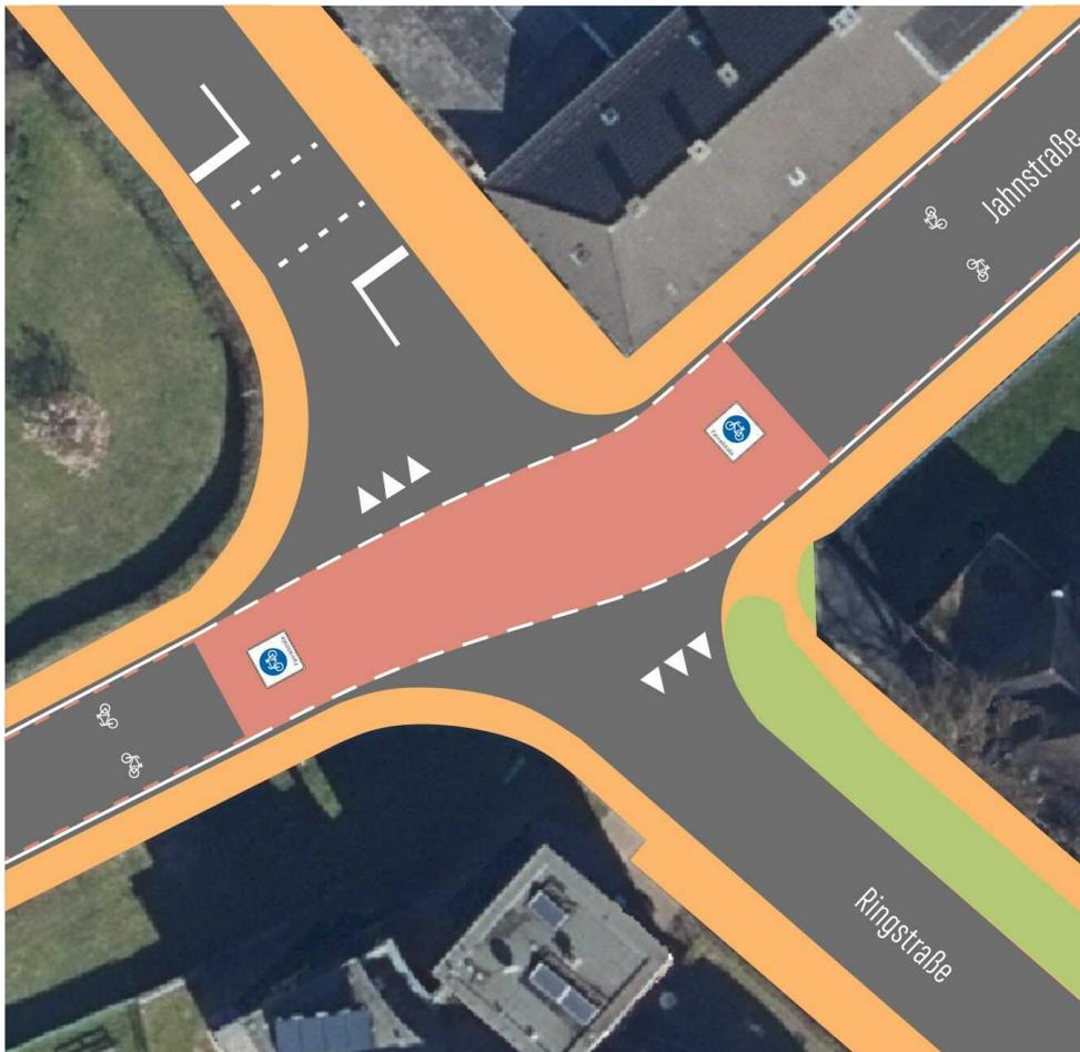
**Bild 70:** Gestaltungsvorschlag eines Knotenpunkts mit Vorrang für den Radverkehr im Verlauf einer Fahrradstraße (K4.05) (Darstellung: IGS mbH, Luftbild: tim-online.de)
