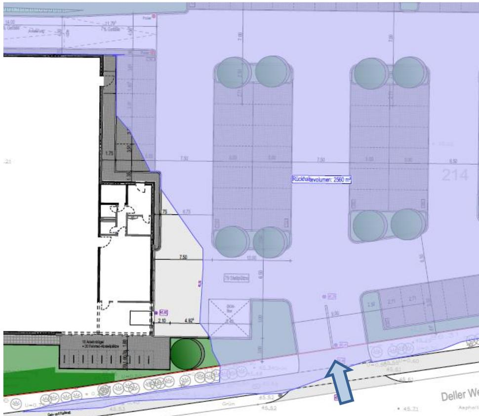
Abbildung 4: Möglicher Weg des zufließenden Wassers aus B221
